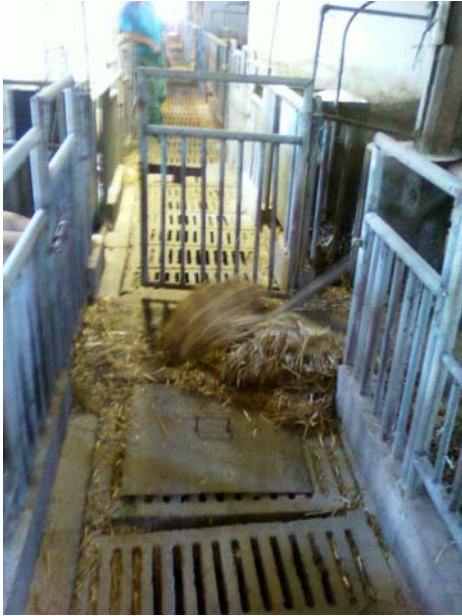
3. kép: lengőlapátos trágyaeltávolító
