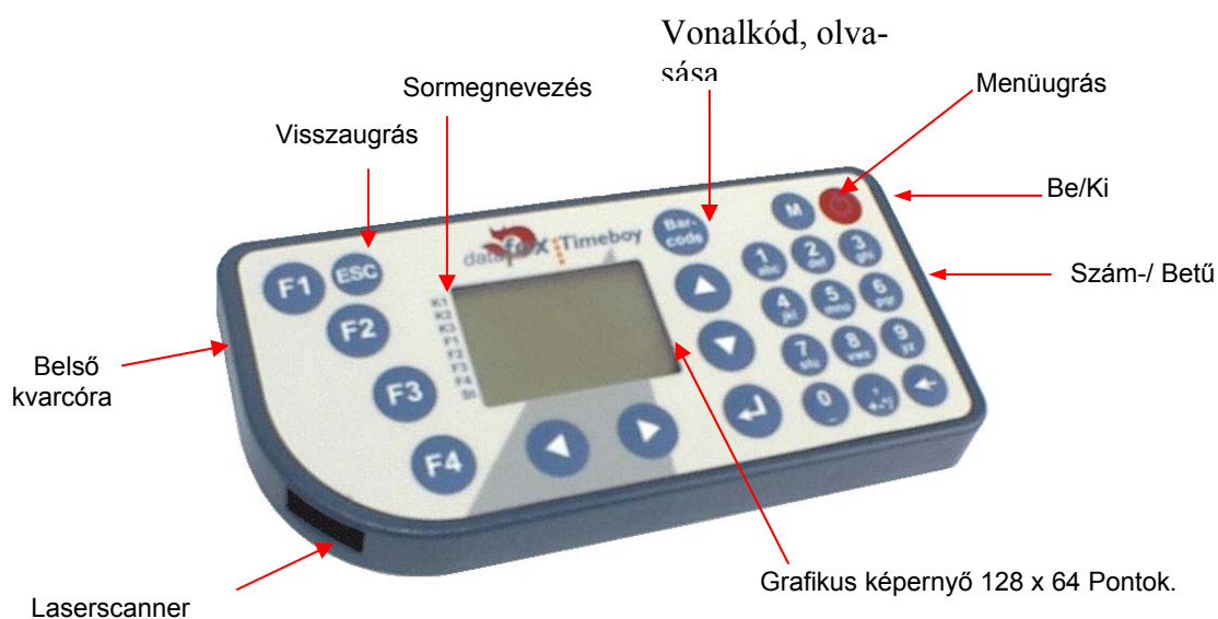
3. ábra: Datafox-Timeboy időrögzítő készülék
